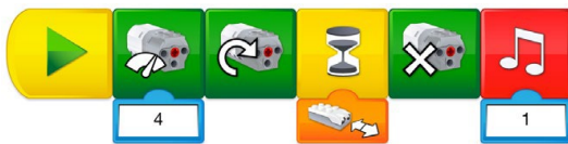
Abbildung 1: Beispiel-Programm mit Lego Software
