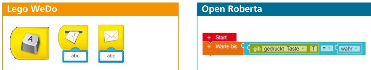
Abbildung 8: Programmstart mit Bedingung im Vergleich
